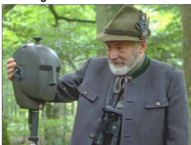
Mithilfe seines Kunstkopfmikrofons – es hat keine Augen aber Mikrophone in den künstlichen Ohrmuscheln – wird ein naturgetreues Hörerlebnis simuliert.
